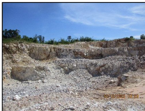
ภาพที่ 1.2 การทำเหมืองแบบขั้นบันไดของโครงการ
